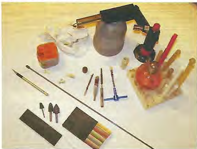
Accessori per preparare le aste: diversi tipi di fiamma, scovoli e feltri per la pulizia interna, pietre, carte abrasive e il deburring-tool.
