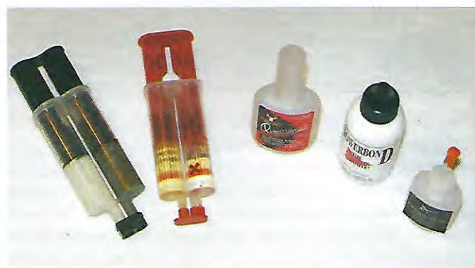
Colle epossidiche e cianoacriliche: la prima sulla destra è specifica per il carbonio ed è a lunga essiccazione (Carbon Express); la seconda rapida (commerciale), la Quantum (Bohning) e la Express Bond (Carbon Express) sono ottime solo per inserti e la Power Bond (Bohning) è l'unica che si scioglie con il caldo.
