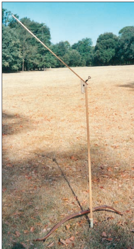
Un semplice strumento di estrema praticità per verificare l'alzo di 45 gradi.
