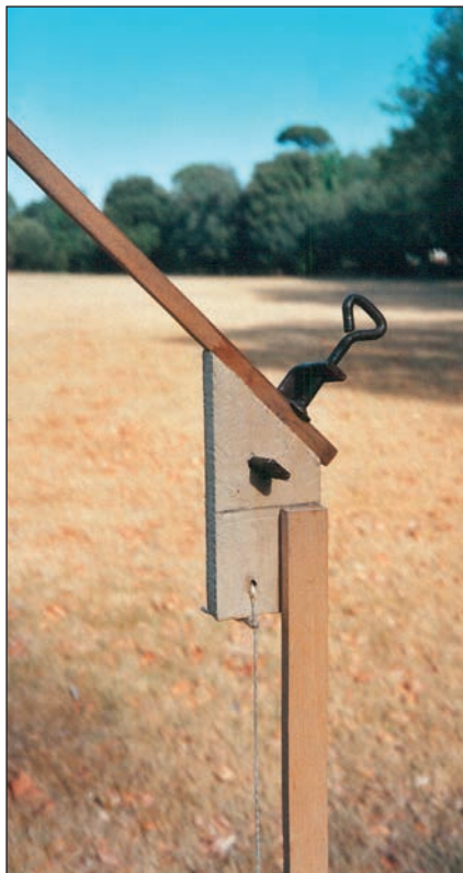
Particolare della giunzione esistente tra le due aste dello strumento.
