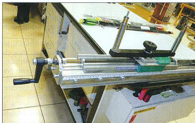
Foto 4. Con la corda in tensione si comincia l'avvolgimento.
