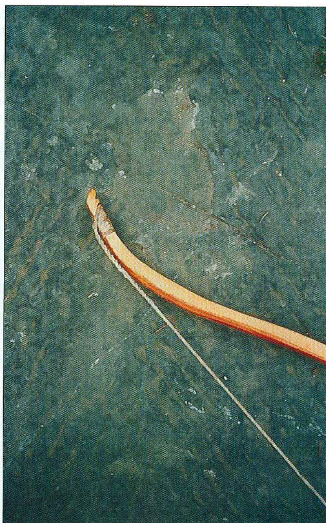
Estremità incurvata a caldo di un esemplare in legno: può rappresentare una valida soluzione per doghe che seguono la corda.
