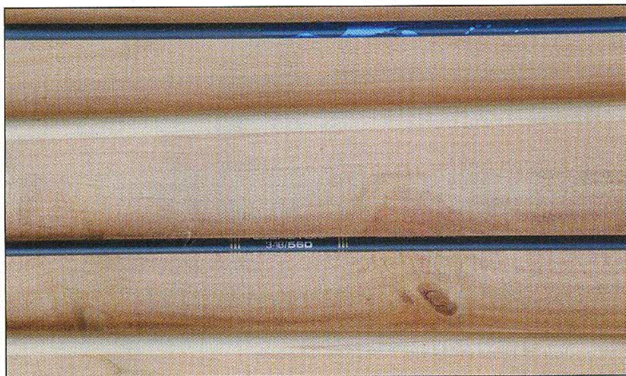
Aste di differente spine e peso. La prima differenza derivante dal peso è esplicitata dalla velocità di uscita della freccia: poco peso maggiore velocità, molto peso minore velocità.
