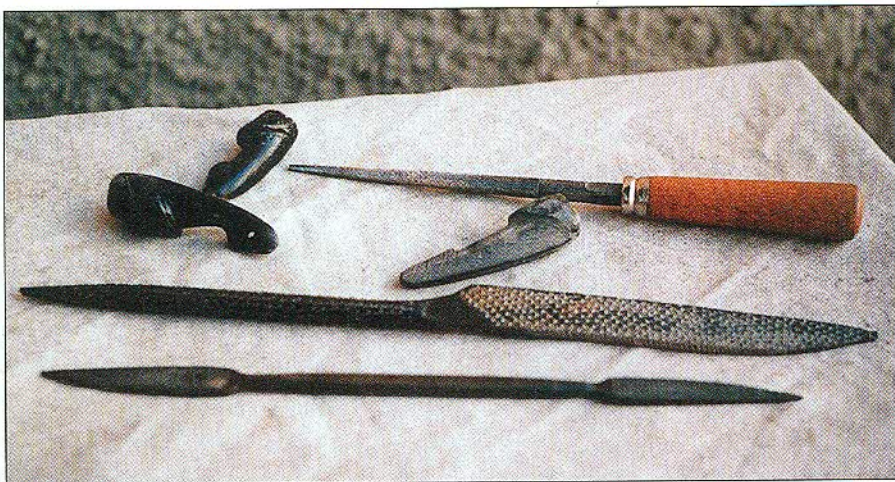
Raspi da ebanisteria e lima "a coda di topo" per sagomare le nocche.
