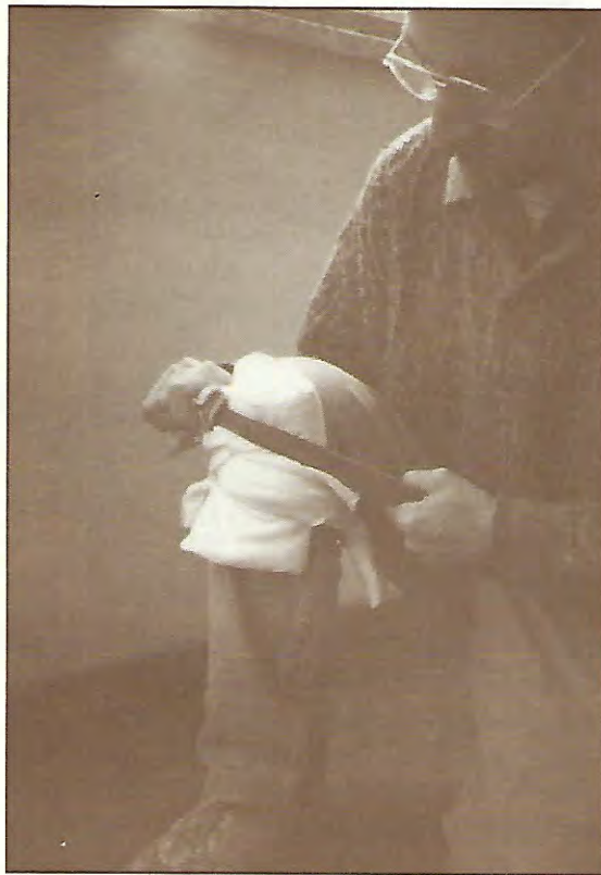
Una stecca di corno viene curvata a caldo.
