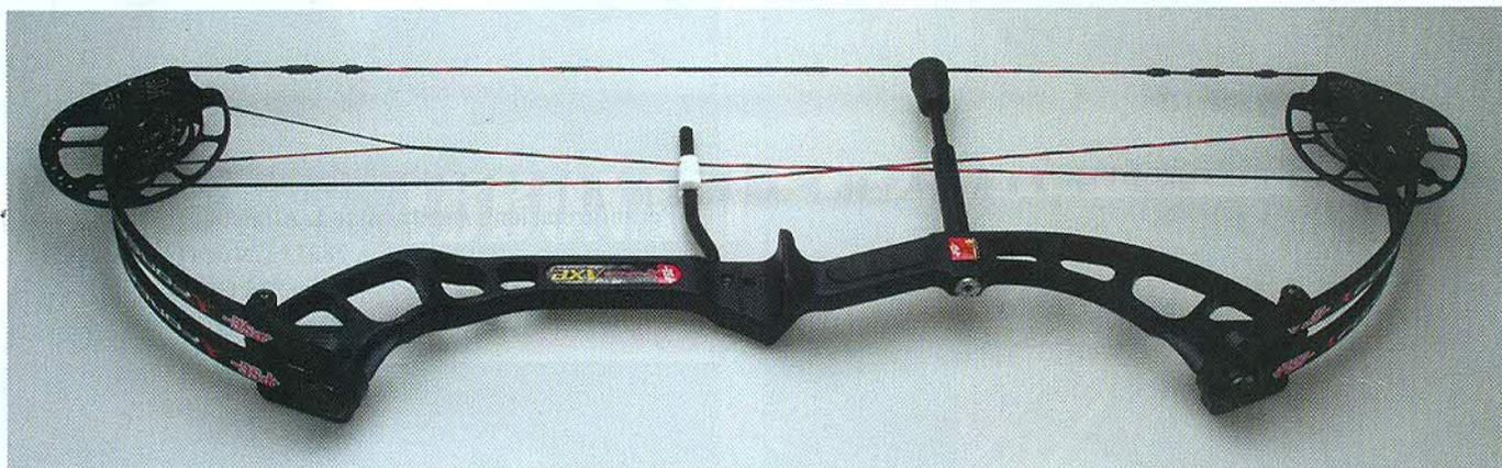
▲ I flettenti, corti e curvi, si innestano nel corpo centrale tramite due slitte basculanti in lega. All'apice, dove si trovano le pulegge, sono paralleli e quindi il movimento è verticale sull'asse dei cavi. Il Backstop blocca la corda nel momento in cui termina il suo lavoro. Le pulegge Axe Cams sono generosamente sovradimensionate e permettono la regolazione dell'allungo da 26 1/2 a 30 1/2 pollici.
