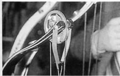
Eccentrico Hoyt: il sistema Yoke è posizionato come 1-a e fissato come 2-b.
