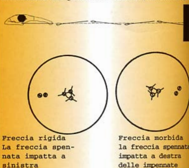
fig. 11 Sbandamenti sul piano orizzontale (Fishtailing)
