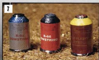
1 I moderni filati per la costruzione delle corde. Da sinistra a destra: Dacron B50, Dacron B66 e Fast-Flite.
