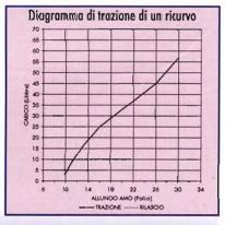
A sinistra: il cronotachigrafo utilizzato per misurare la velocità della freccia. Al centro:diagramma di trazione di un long bow; la curva è molto lineare a causa della particolare struttura di questo arco che non permette grandi accumuli di emergia.
