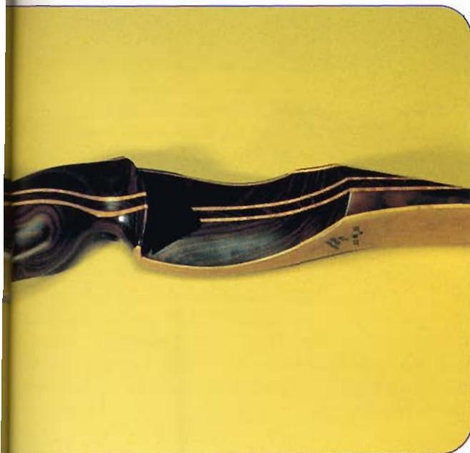
Nel test di trazione il Blacktail Elite è arrivato a 57 libbre ad un allungo Amo di 30 pollici. Ricordiamo che l'allungo Amo è l'allungo netto, misurato dal punto di perno, più 1 pollice e  $\frac{3}{4}$ . È un arco stabile e preciso, nonostante i suoi soli 900 grammi di massa.
