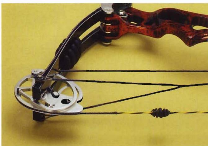
7" ed un tiller uguale a zero. Con questa geometria con i flettoni quasi paralleli non è molto facile misurare correttamente il tiller che, comunque, non ha possibilità di essere variato. È risultato un let-off, cioè la riduzione del carico, del 67 per cento ad un allungo Amo di 29" (allungo netto al punto di perno più 1 pollice  $\frac{3}{4}$ ).
