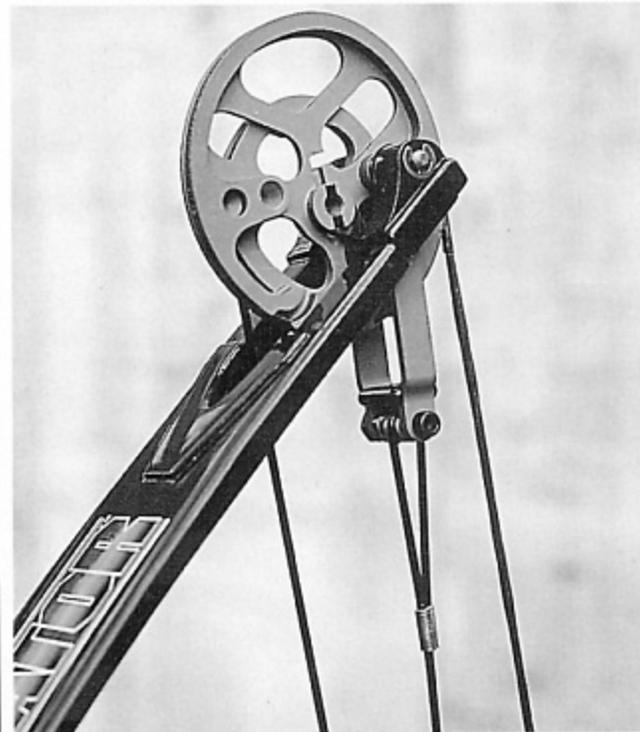
**Sopra: il flettente del Carrol Dominator, in grafite ad unica curvatura e dall'aspetto massiccio, è trattato per una particolare resistenza ai carichi torsionali (a sinistra). Il riser, dal disegno decisamente riflesso con un ampio scasso nella finestra, è in alluminio fresato dal pieno (a destra).**
