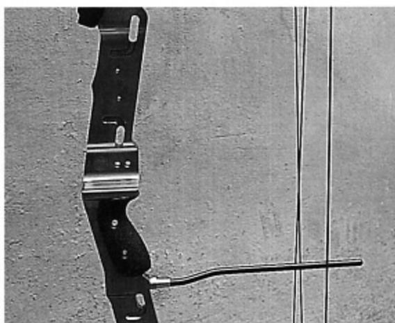
allungo di 30". Tarato al massimo possibile il Pse Infinity LD 2000 in esame ha espresso un picco massimo di 53 libbre, con un let-off del 58% ad un allungo AMO di 30" (allungo netto al punto di perno più 1 pollice 3/4). L'altezza della corda, la distanza di quest'ultima dal punto di perno, è risultata di 10" 1/8 con un tiller uguale a zero, cioè uguale tra il flettente inferiore e quello superiore.
