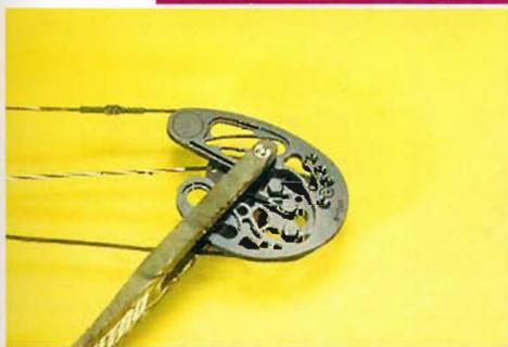
persa: per isteresi (3,8 ft lb). Ottimo è il rapporto tra l'energia elastica potenziale ed il carico (Eep/c), pari a 1,39. Come c'era da aspettarsi la velocità di uscita della freccia è molto alta (233 fps).
