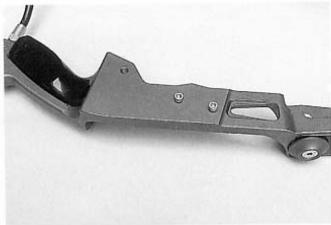
Sopra: particolare del riser, in alluminio Anticorodal fresato ed alleggerito, e della grip in materiale plastico; numerose boccole filettate sono predisposte per il montaggio degli accessori. A fianco: puleggia circolare ad unica gola. A fronte: il riser in vista laterale (sopra) ed il preciso sistema di attacco dei flettenti denominato Spl (sotto).
